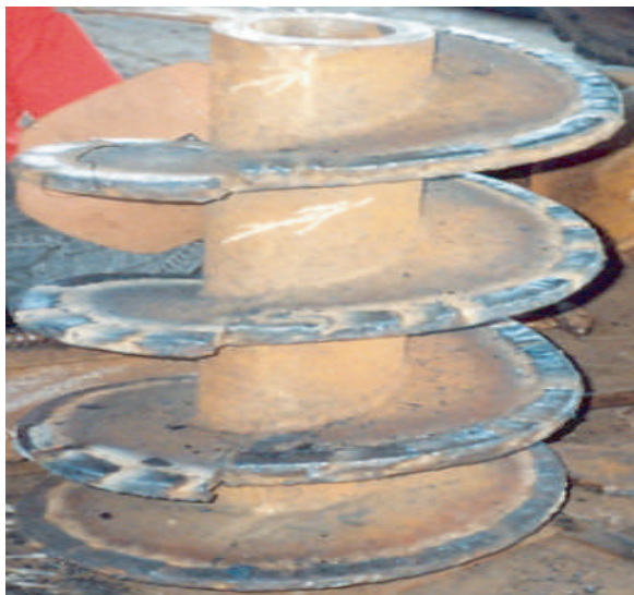
Hàn đắp vị trí mòn bằng que hàn Nikko
