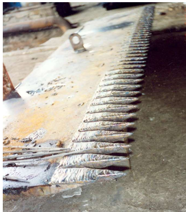
Răng lược được hàn đắp bằng que hàn NS SUGAR
